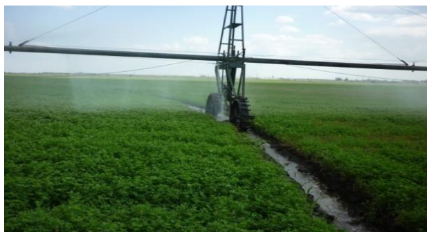
Рисунок 1.7 – Колееобразование ДМ «Фрегат», приводящее к пробуксовке машины и разрушению почвы
