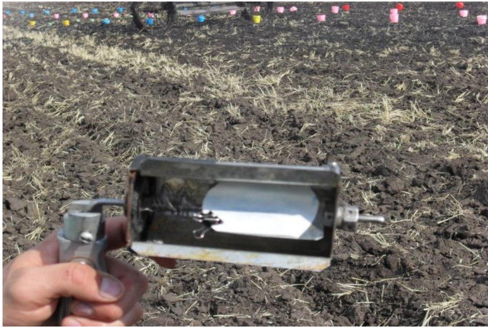
Рисунок 3.3 – Определение крупности капель дождя при помощи бумажного фильтра, установленного в улавливателе капли
