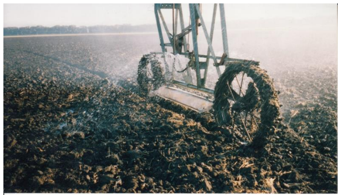
Рисунок 2.13 – Работа тележки ДМ «Волга-СМ» с подтележечным щитком
