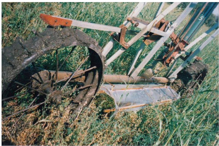
Рисунок 5.14 – Установка подтележечного щитка на раме тележки ДМ «Волга-СМ»
