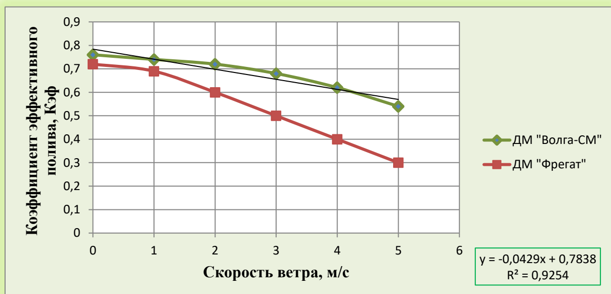
Рисунок 5.9 – Изменение коэффициента эффективного полива ДМ «Волга-СМ» и ДМ «Фрегат» при обычной расстановке стандартных штуцеров от скорости ветра
