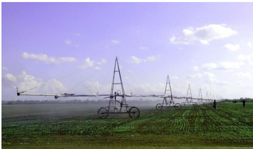
Рисунок 5.16 – Опытный образец многофункциональной низконапорной дождевальной машины кругового действия с полиэтиленовым трубопроводом «Волга-СМ» в работе
