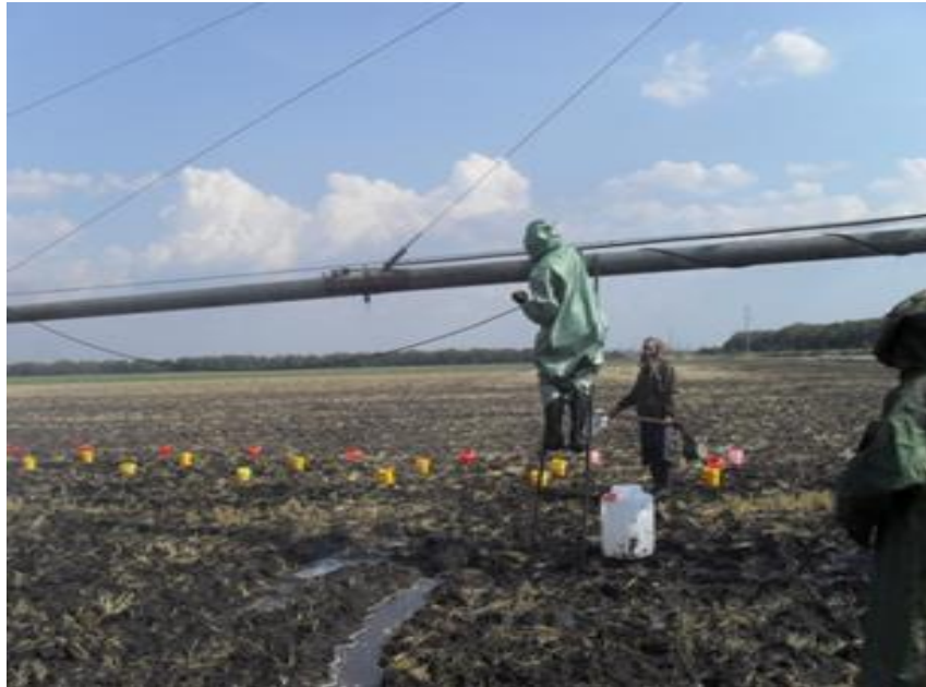
Рисунок 3.6 – Замер давления на выходе струи дождевальной насадки при помощи трубки Пито
